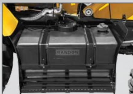
Producido con material plástico anti llamas (ICORENE 1613), elimina el riesgo de oxidación interna. Posee protección metálica inferior, trasera y lateral y fue probado de acuerdo con la norma NBR ISO 11.472.
