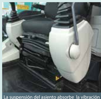
La suspensión del asiento absorbe la vibración
