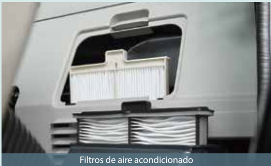
Filtros de aire acondicionado
