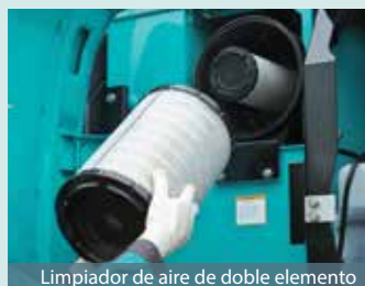
Limpiador de aire de doble elemento
